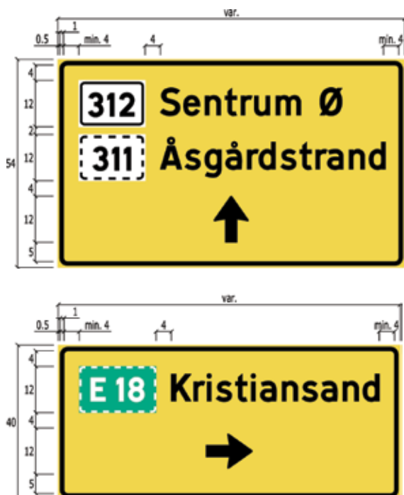
Figur 4-4.42 Eksempler på utforming av skilt 719.12
