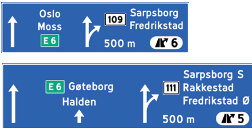
Figur 4-4.30 Eksempler på portalorienteringstavle 709.3
