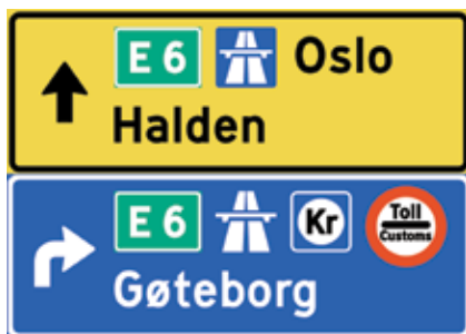
Figur 4-4.83 Utforming av symbol 761 på skiltenhet eller felt med blå og gul bunnfarge
