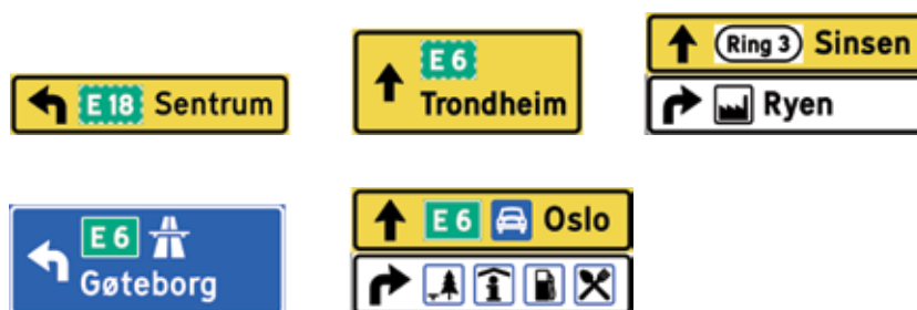
Figur 4-4.25 Eksempler på portalorienteringstavle 709.11
