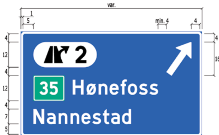
Figur 4-4.46 Eksempel på utforming av skilt 719.4
