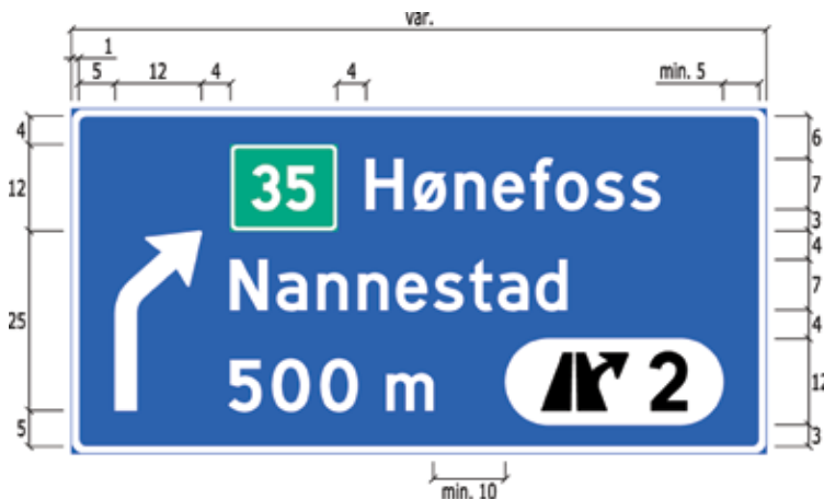
Figur 4-4.33 Eksempel på utforming av skilt 709.4
