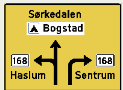
Figur 4-4.10 Eksempel på felt med avvikende farge
