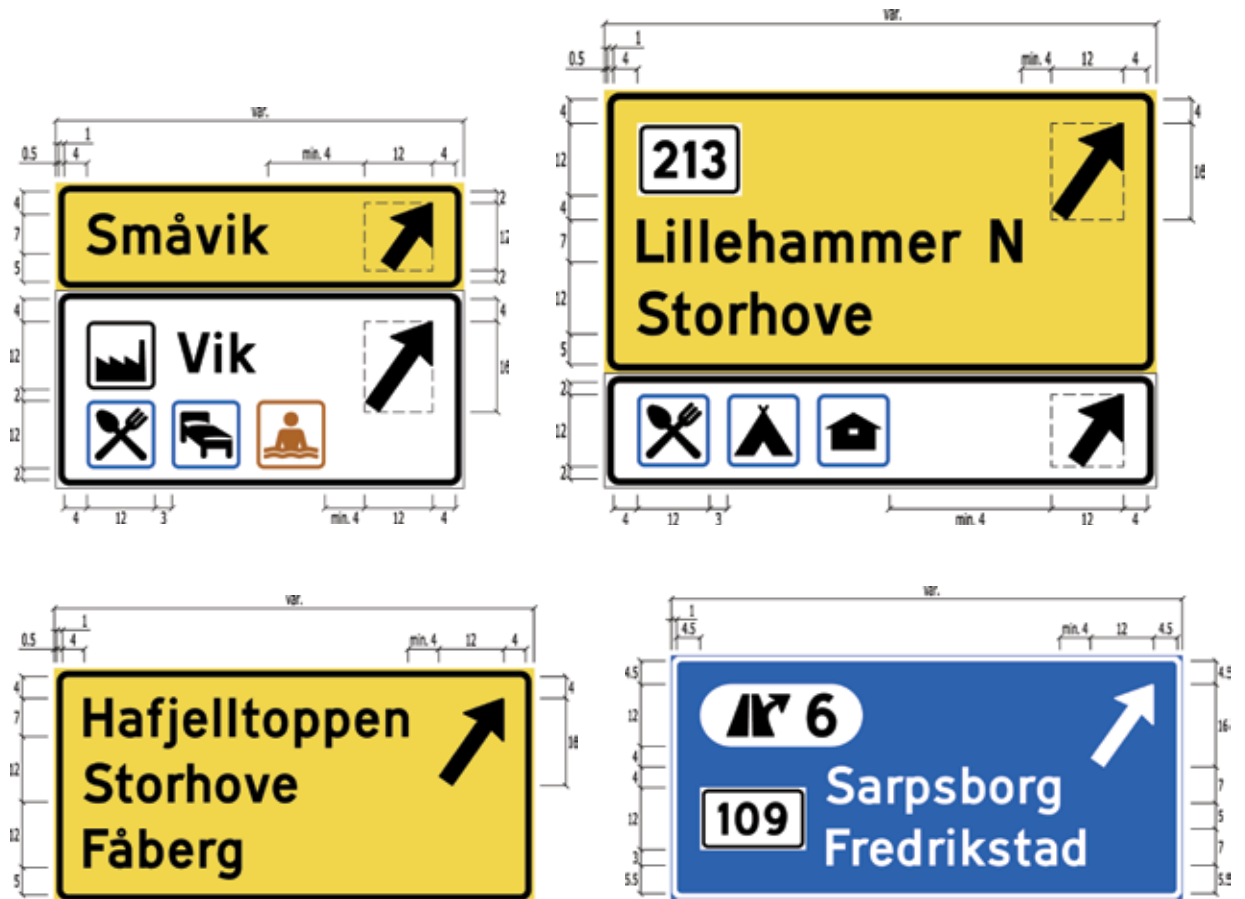
Figur 4-4.38 Eksempler på utforming av skilt 715
