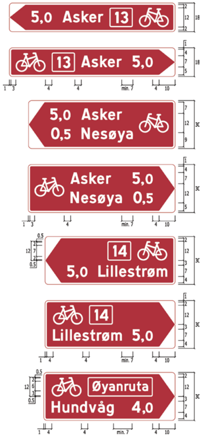
Figur 4-4.73 Eksempler på utforming av skilt 751. Alle mål i 1/7 H.
