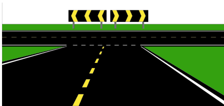
Figur 2-2.5 Eksempel på bruk av bakgrunnsmarkeringer i T-kryss
