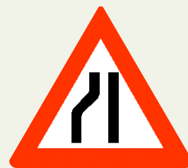
106.3 (Innsnevring på venstre side)
