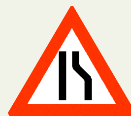
106.2 (Innsnevring på høyre side)
