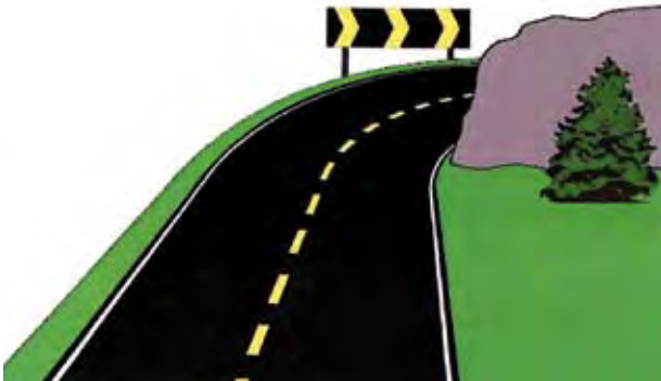
Fig. 32 Eksempel på bruk av bakgrunnsmarkering i kurve med dårlig sikt
