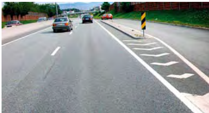
Fig. 38 Eksempel på bruk av skilt 906 Hindermarkering.
