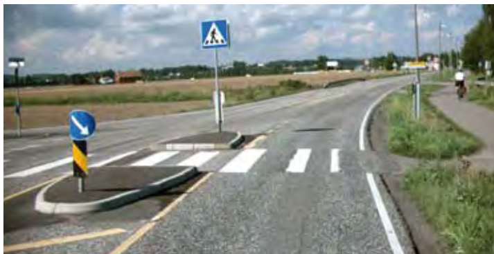
Fig. 27 Eksempel på plassering av gangfeltskilt på trafikkø
