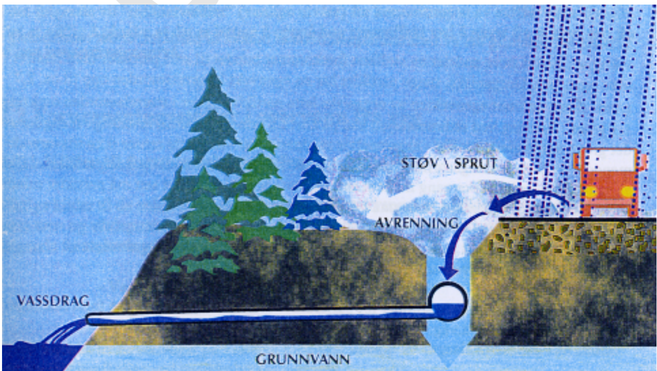
Figur 4.1. Prinsippskisse som viser overvannsavrenning og forurensningsspredning fra veg.
