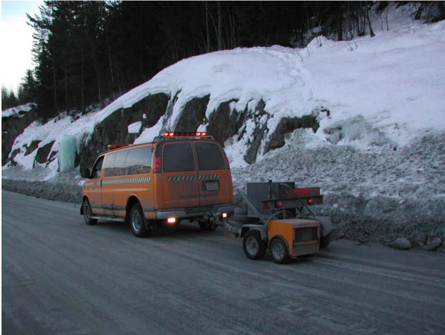
Figur 3.3: Friksjonsmåling med Roar Mark I 16.01.2003
