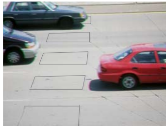
Figur 3: Induktive sløyfer i vegbanen.
