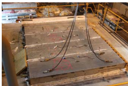
Kulvertelementer rett etter test
