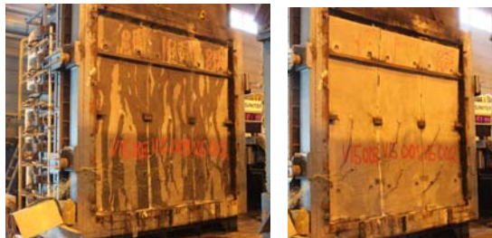
Veggelementer uten PP-fiber under test
