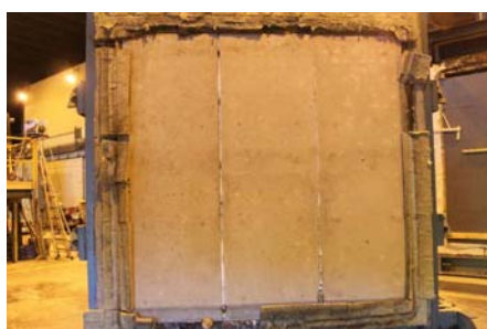
Veggelementer med PP-fiber etter test
