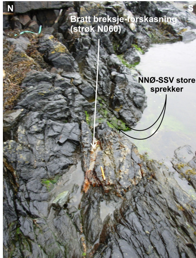
Figur 46. Strukturer ved lokalitet H4 (se Figur 42 for plassering). Bildet viser en 4 cm bred breksjesone i en forkastning med N060 strøk og steilt fall, med svært oppsprukket fjell rundt. I tillegg forekommer steile sprekker med NNØ-SSV strøk.
