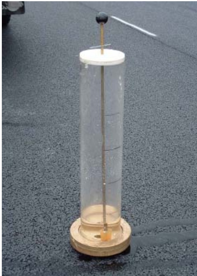
Figur 5 Utstyr for bestemmelse av vegdekkenes permeabilitet (ref 18)
