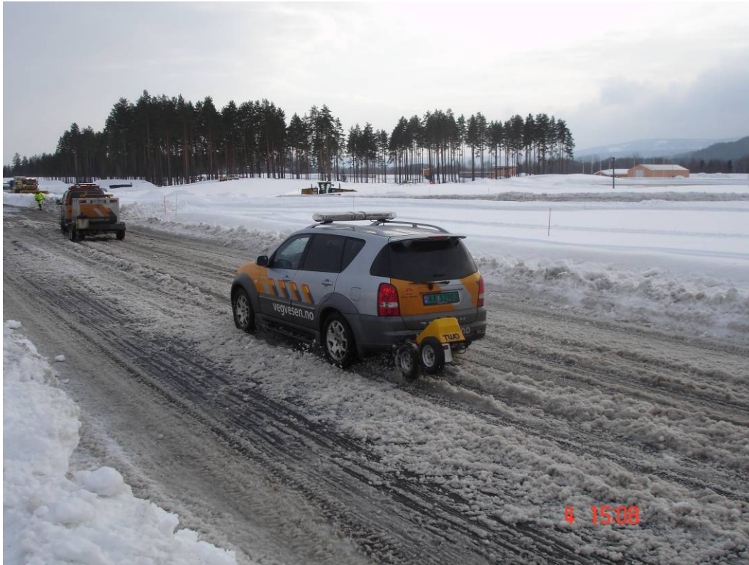
Figur 2-23: Klargjøring av bane for slapseforsøk (friksjonsmåleren er ikke i målemodus)
