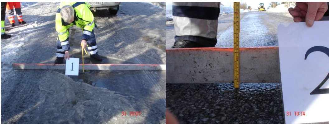
Figur 3-26: Test 1, RSS 200 Øveraasen (nr.1) 50 mm spor og Pon Equipment (nr.2) 15 mm spor
