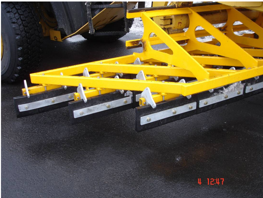
Figur 2-11: Høvel fra Pon Equipment, detaljbilde av grind m/slapselameller
