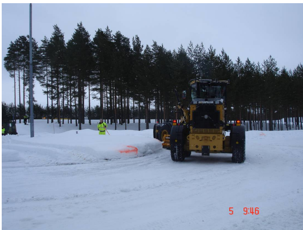
Figur 3-5: Manøvreringstest med høvel fra Pon Equipment
