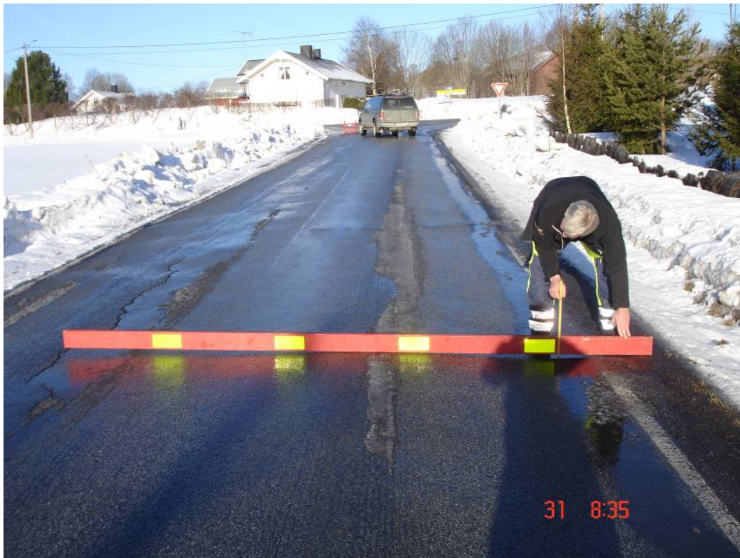
Figur 3-22: Teststrekning på Fv 544. Spordybde målt til 45 mm
