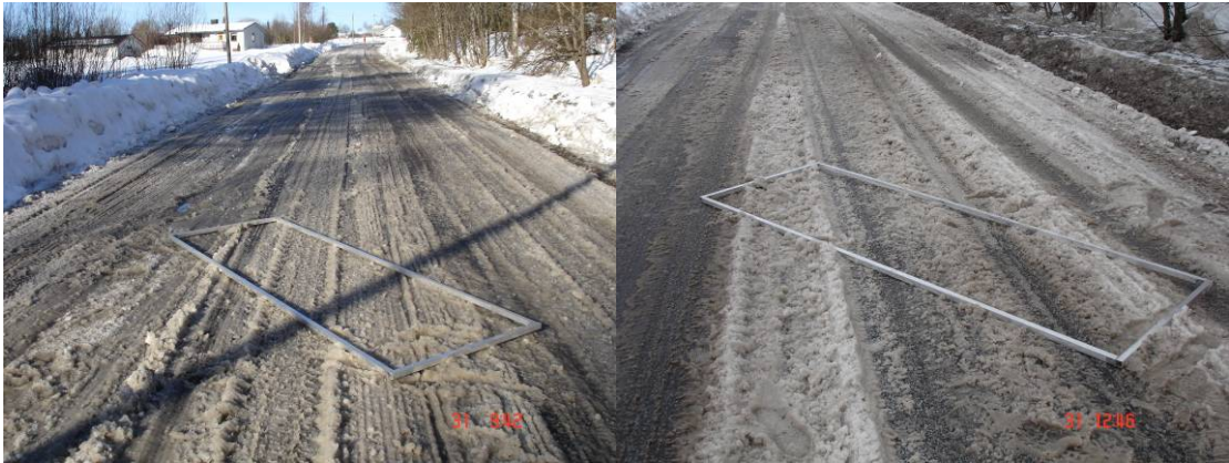
Figur 3-25: Utlagt slaps før forsøk
