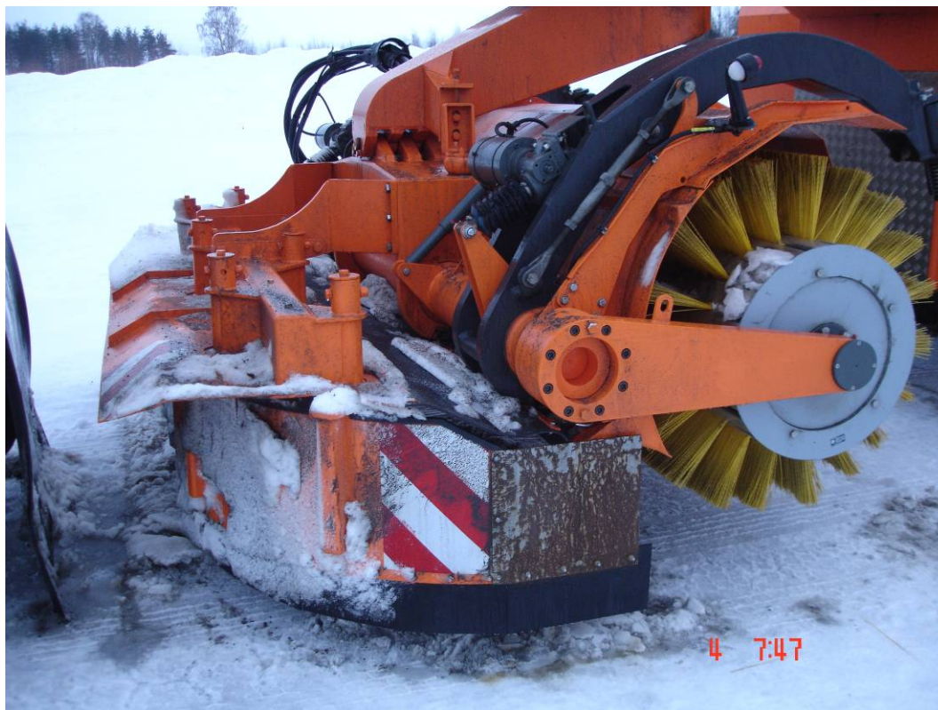
Figur 2-8: RSS 200 fra Øveraasen, detaljbilde av kost og kassett m/lameller
