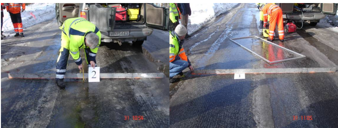
Figur 3-27: Test 2: Pon Equipment 55 mm spor og RSS 200 Øveraasen 15 mm spor
