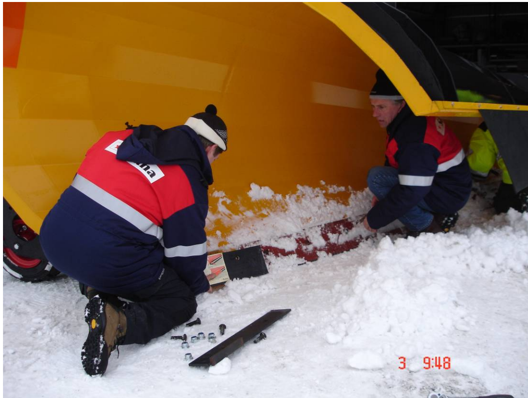
Figur 2-13: Montering av Joma 6000 skjær
