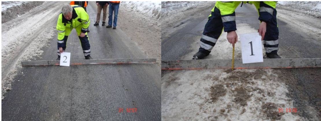
Figur 3-28: Test 3, Pon Equipment 20 mm spor og RSS 200 Øveraasen 60 mm spor
