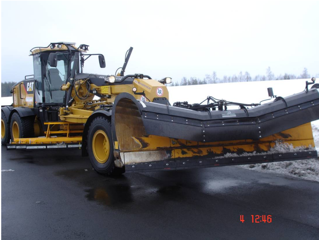
Figur 2-10: Høvel fra Pon Equipment
