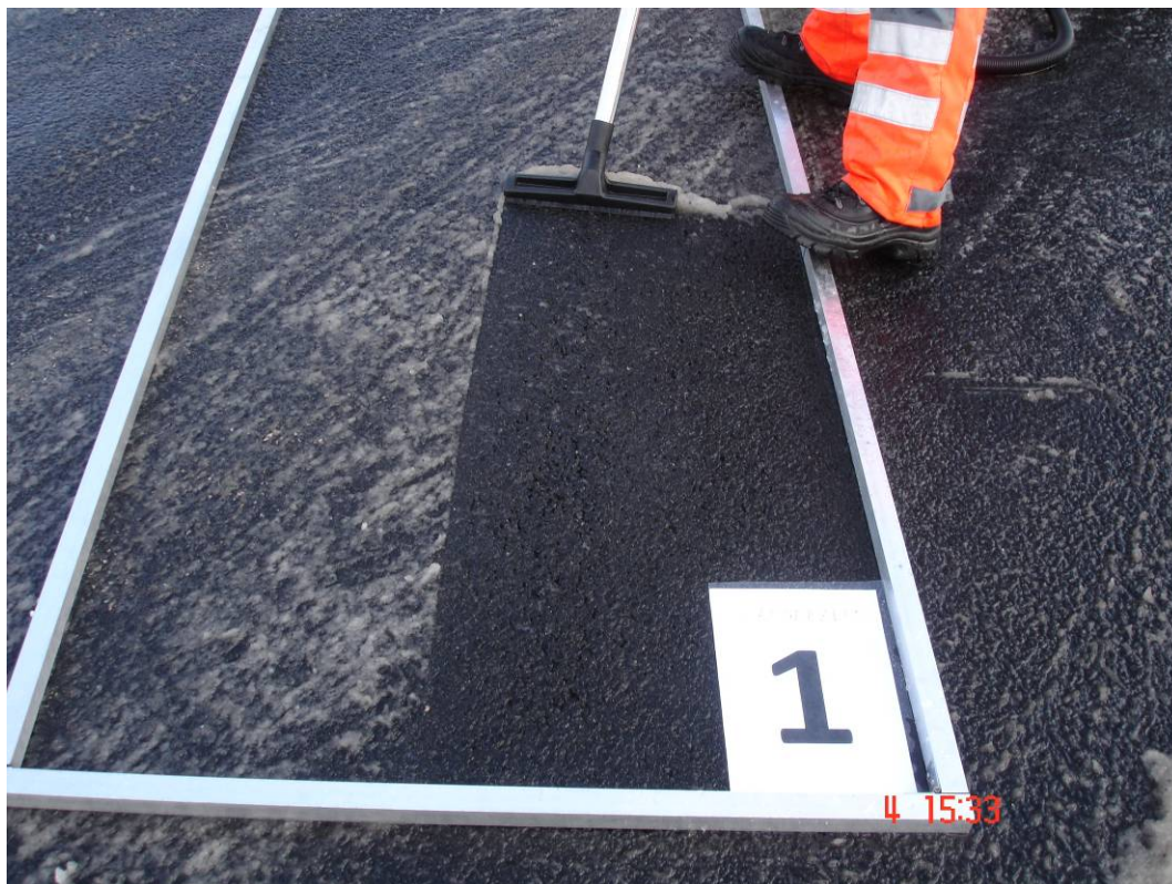
Figur 2-17: Oppsamling med støvsuger
