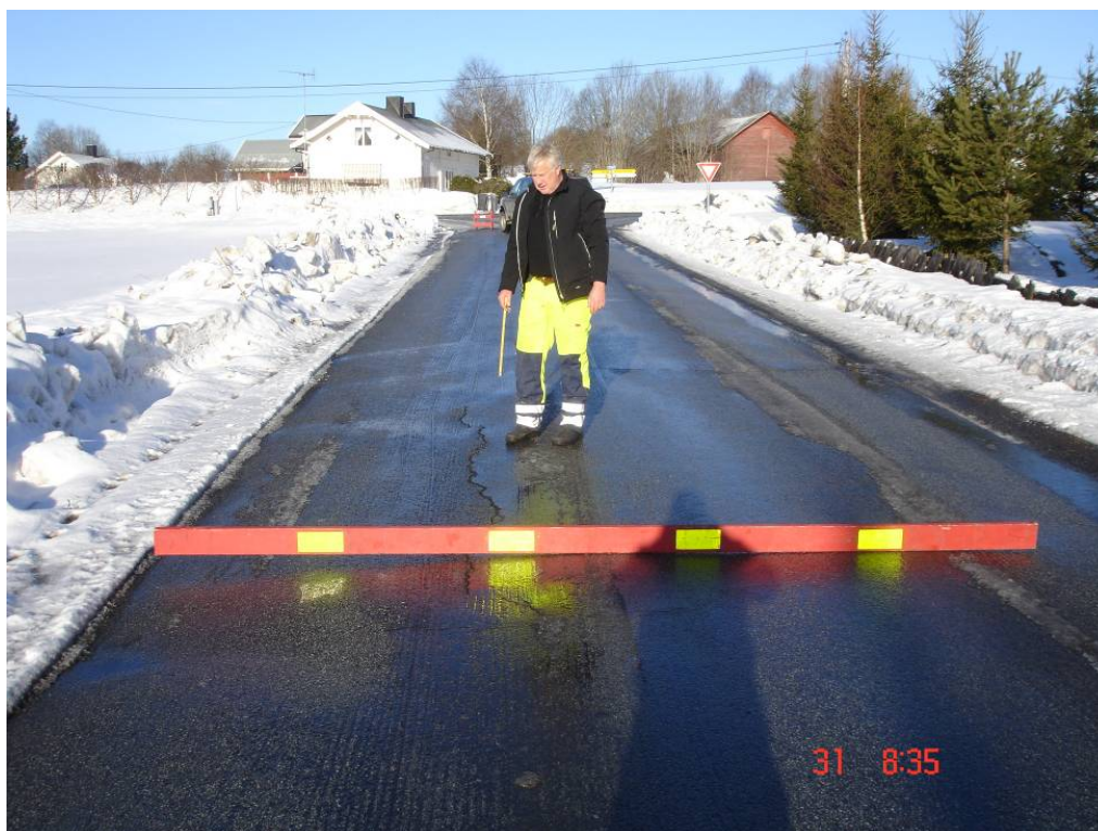
Figur 3-23: Teststrekning på Fv 544. "Tverrfall" fra senterlinje på 100 mm
