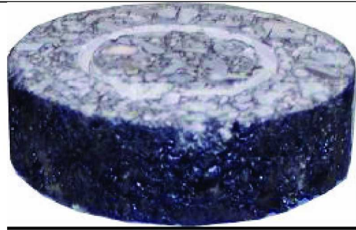
Figur 26: Ab11 prøve kappet i to
