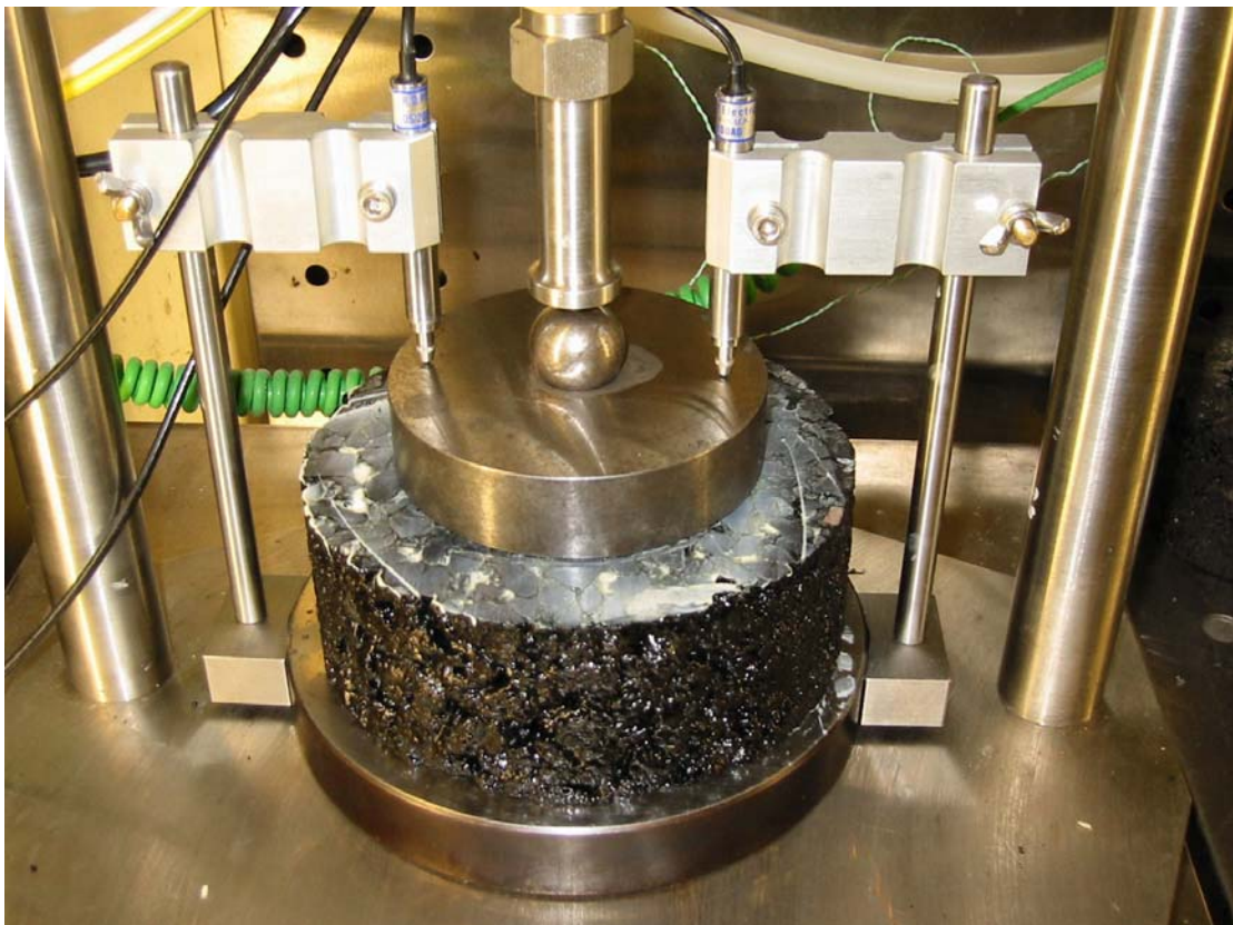
Bilde 3: Oppsett av prøverigg for dynamisk kryp test i NAT.
