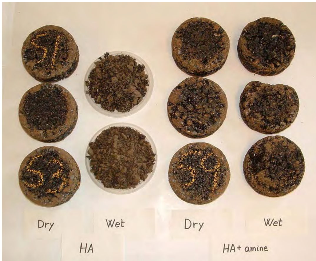
Figur 4. Hadeland-prøvene etter Cantabro-test (tørre og våtlagrede). Prøver uten amintilsetning i de to kolonnene til venstre.
