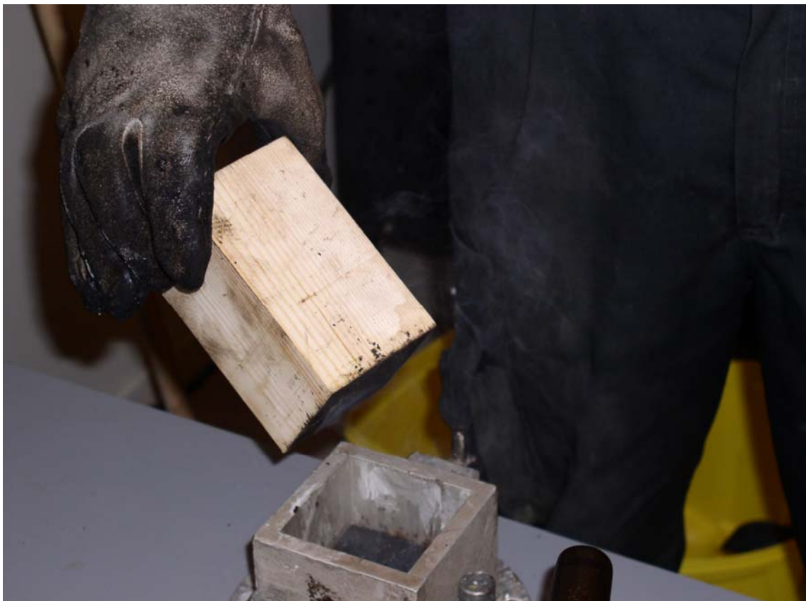
Figur 3 Komprimering av prøve ved bruk av stampekloss
