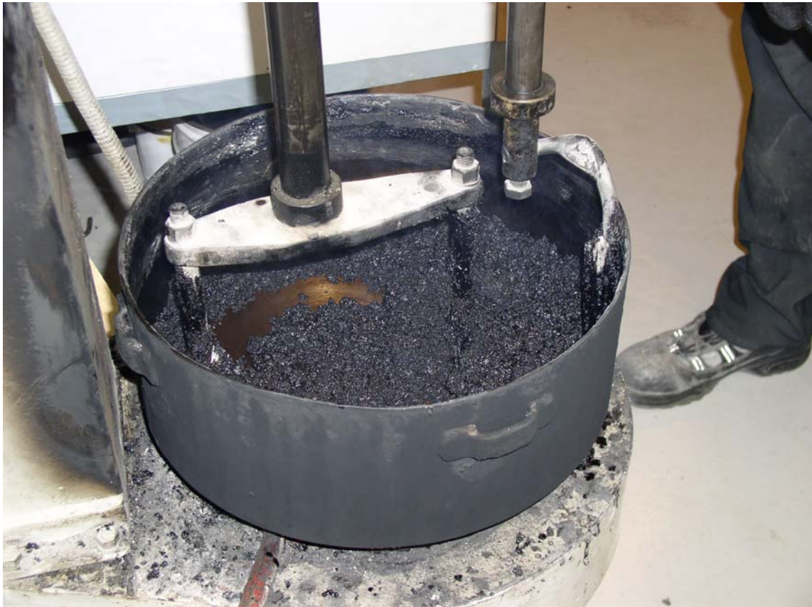
Figur 2 Blanding av asfaltmasse, Sta 2
