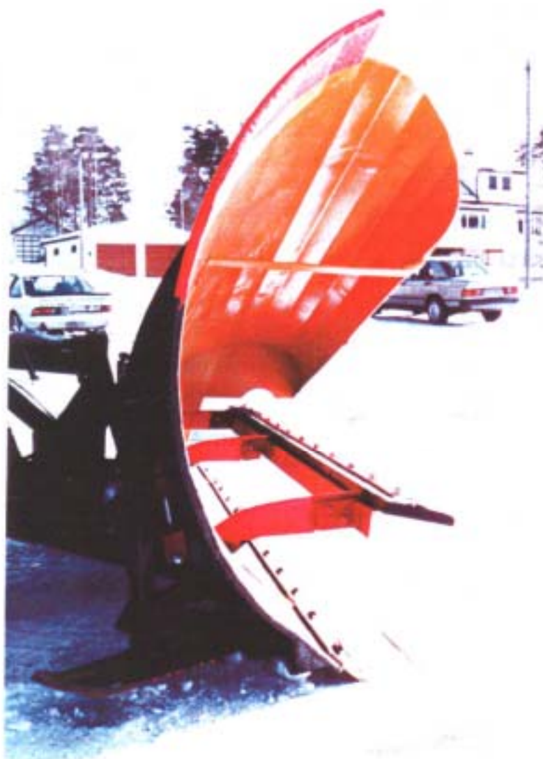
"Steinslandplogen", detalj som viser gummiskjæret
