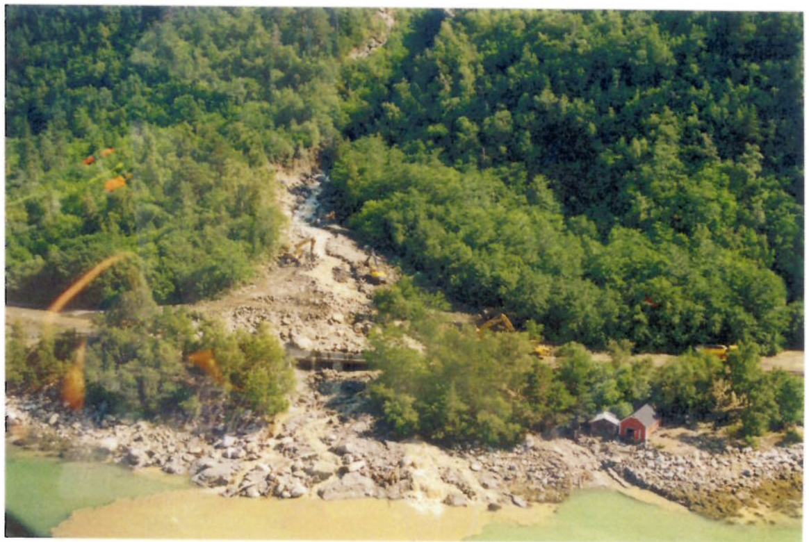
Foto nr. 2. Rv. 70 på elvevifta for Sandvikselva. Merk størrelsen på steinblokkene flomskredet har ført med seg. Foto mot Ø.
