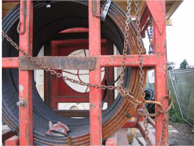
Figur 15 Rust på spennstålkabel (0,6'' lisse) på trommelen. Trommelen ble avvist på plassen
