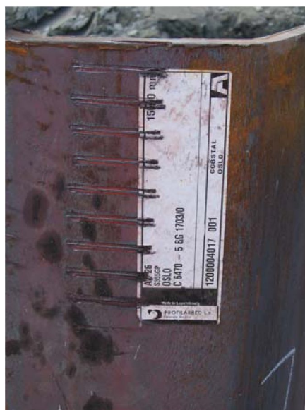
Figur 19 Merking av stådybel og spunt skal stemme overens med sertifikater
