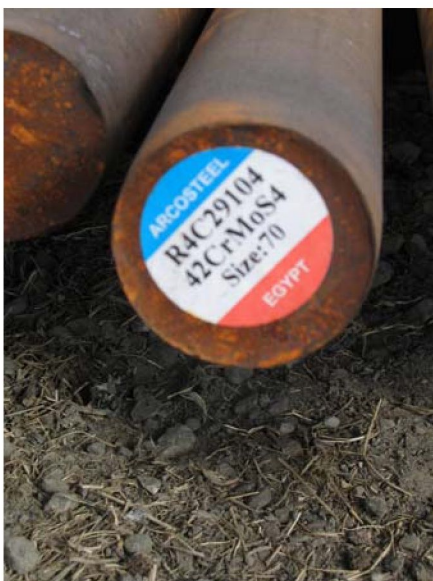
Figur 19 Merking av stådybel og spunt skal stemme overens med sertifikater
