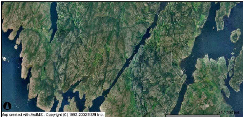
Figur 2.4a. Pre-kritt 'etse'-flate på Hvaler, Østfold. De lokale lineære depresjonene kommer fram som tydelige daler eller sund mellom øyer og tolkes som eroderte dypforvitringssoner langs forkastninger og sprekkesoner.
