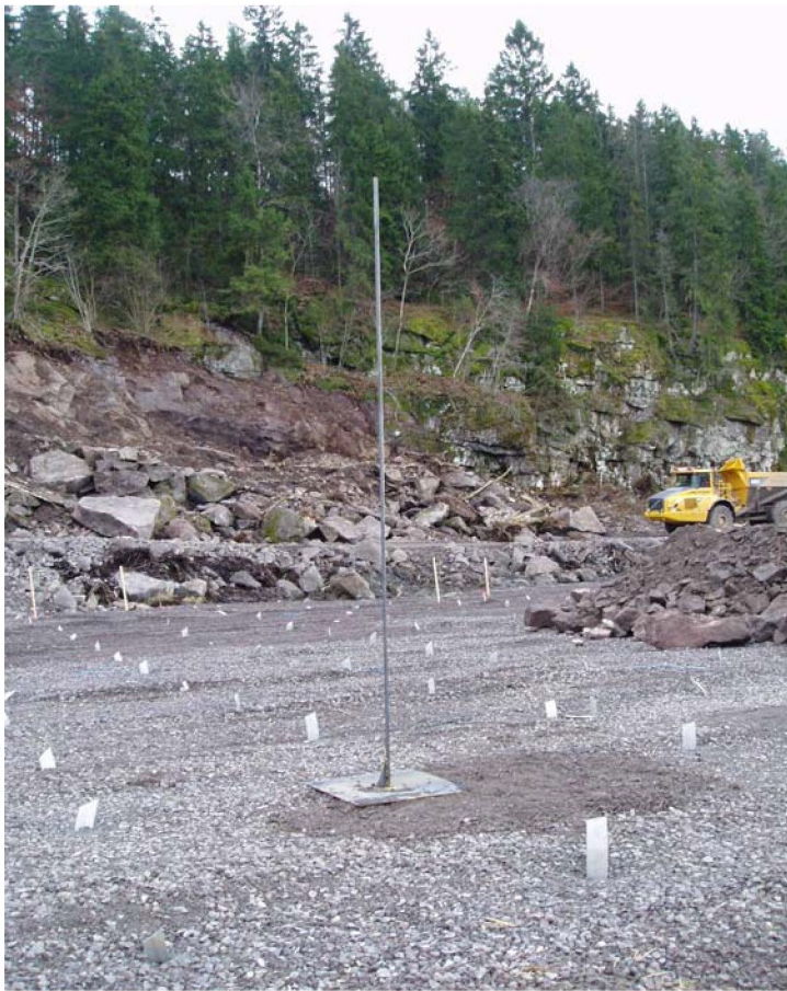
Bilde 9. Tradisjonell setningsmåler med plate og stang, plassert på ferdig utlagt gruspute.
