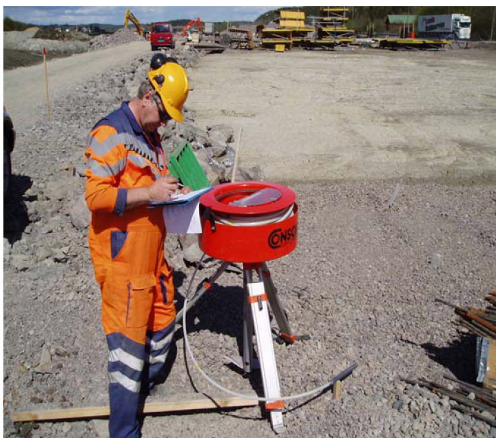
Bilde 8. Måling av setninger med slangesetningsmåler.
