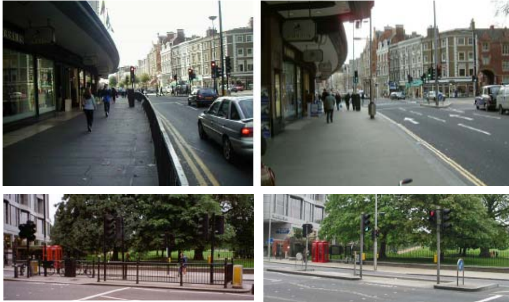
Figur 5.10 Det mest kontroversielle grepet i gaten var fjerning av vegrekkverkene både mellom fortau og gaten, men også i midtrabattene i forbindelse med forskjøvete fotgjengeroverganger. Tross advarsler om det motsatte, har det vært en nedgang i ulykker.
