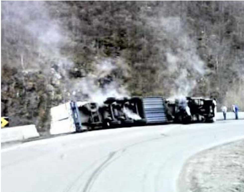
Bilde viser veltet vogntog på veg ned rv. 52 Hemsedalsfjellet. Det røyker kraftig i de bremsene som har fungert.
