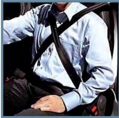
Saab sitt forslag til sikrere bilbelter. Disse vil fange opp krefter bedre ved sidevegs kollisjoner.
