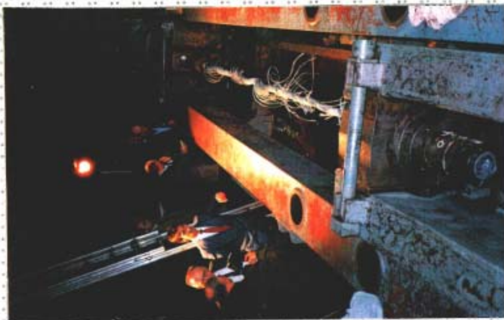
Fig. 3.6 Bruddforsøk foretatt. For samtlige forsøk kom brud- det i kabelen, som det skal gjøre, og ikke i kabel- hodet eller innstøpingen.
