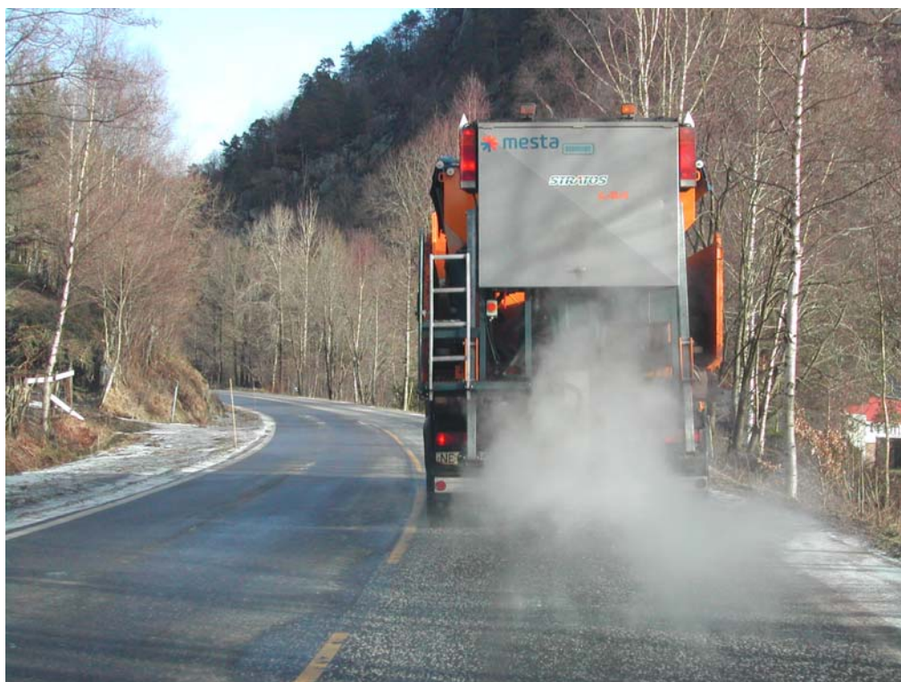
Figur 4: Befuktet salt med kokende vann som befuktingsvæske
