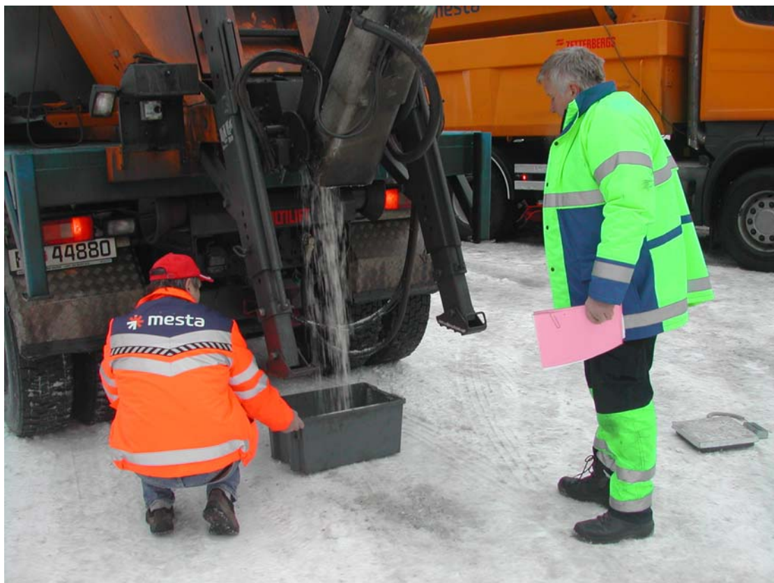
Figur 5: Oppsamling av tørt salt som ledd i kalibreringen
