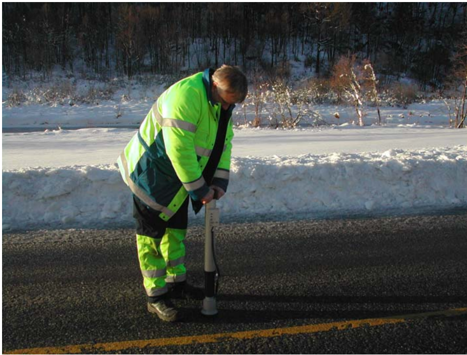
Figur 8: SOBO 20 i bruk for måling av restsalt
