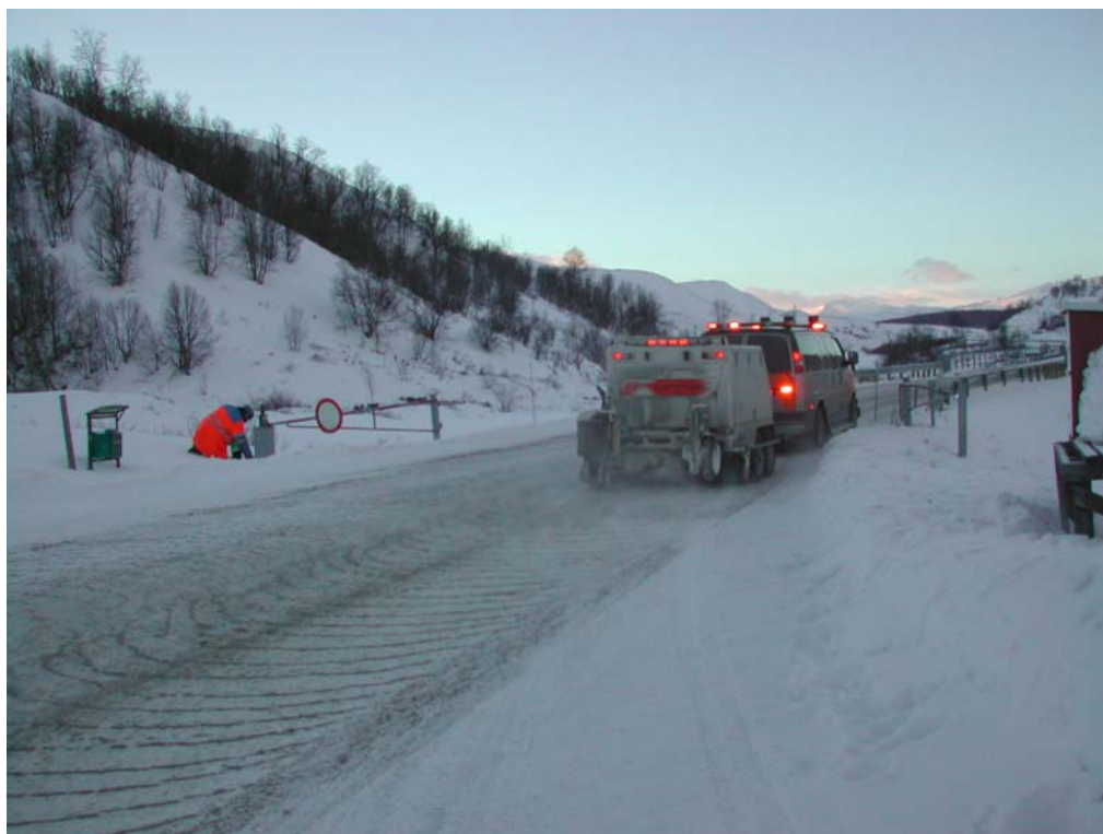
Figur 9: Friksjonsmåling etter strøing med Fastsand
