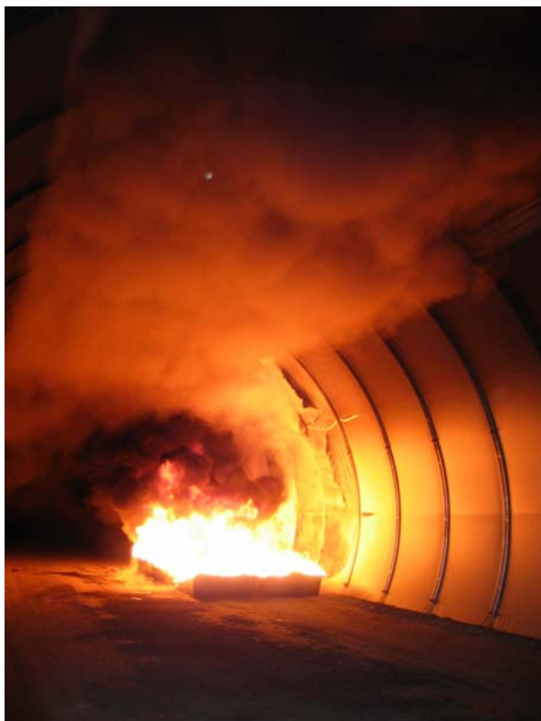
Figur 10 Branntest GW Tunnelhvelv
