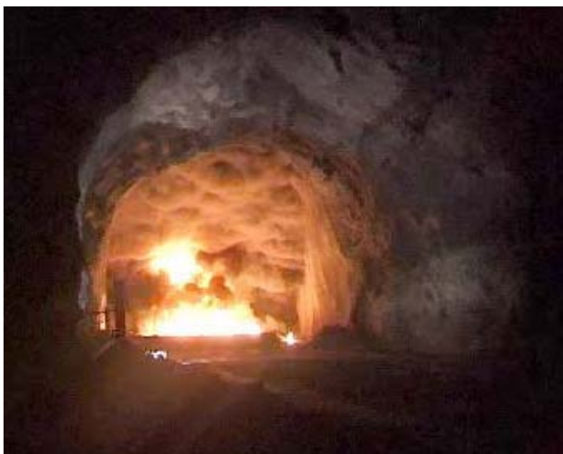
Figur 30 Brannutviklingen umiddelbart etter antennelse
