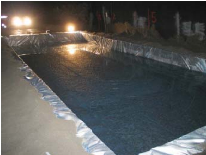
Figur 29 Dieselpøl på 40 m 3 med plass til 11 000 l diesel tilsvarende en tankbil
