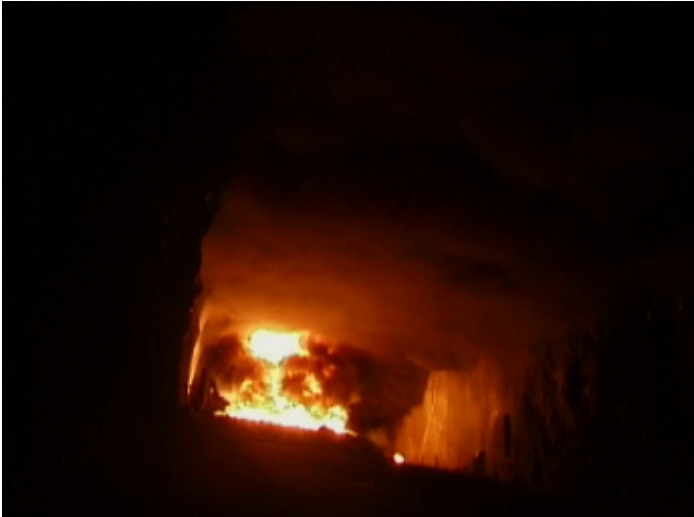
Figur 15 Brannen ca. 1 minutt etter antennelse, røyken har passert 50 m oppstrøms.
