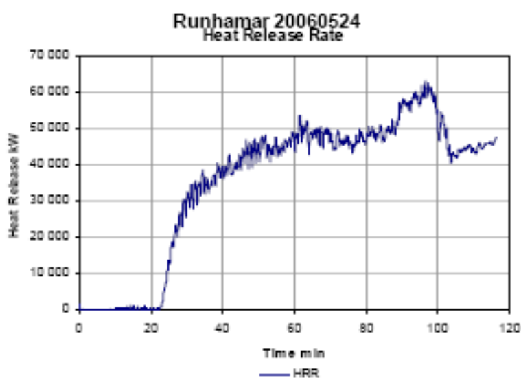
Figur 3 Varmeavgivelse fra 20 m 2 dieselpøl brann. (Målingen ligger om lag 15 minutter etter brannstart)
