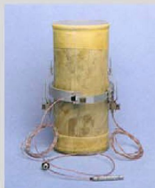
Fig. 6 Hall Effect og LVDT tøyningsomformere
