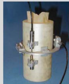
Fig. 6 Hall Effect og LVDT tøyningsomformere
