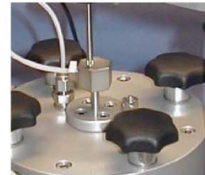
Fig. 3 GDS Rowe og Barden konsolideringsselle med eksternt aksialt tøyningmålingspunkt
