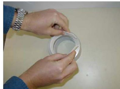
Fig. 7 Innsetting av radiale drensfilter
