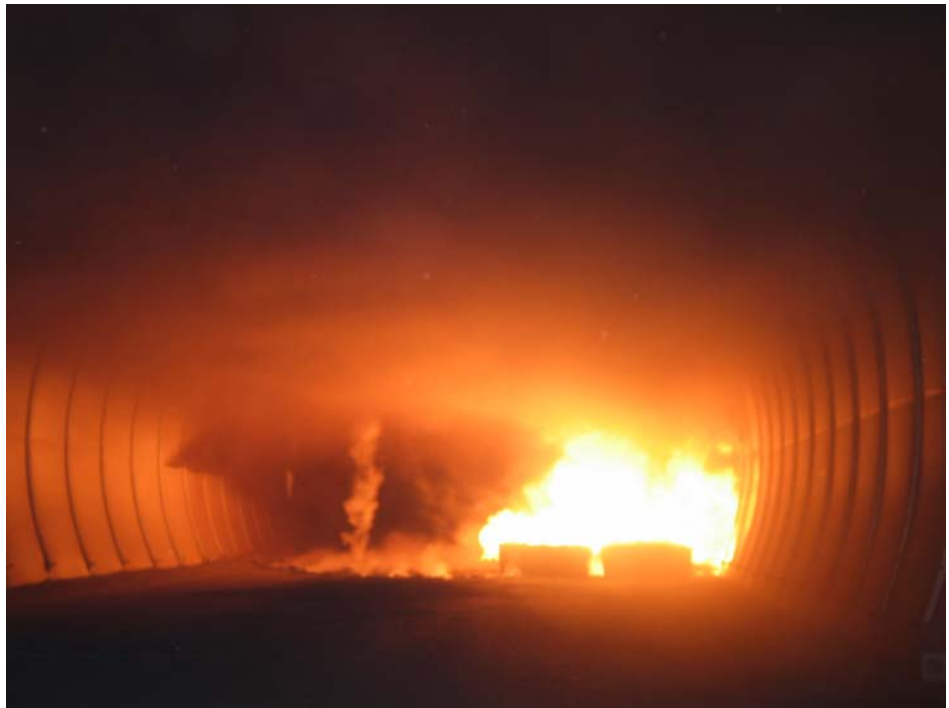
Figur 5. Duken brenner/smelter i taket i området nær brannkilden.
