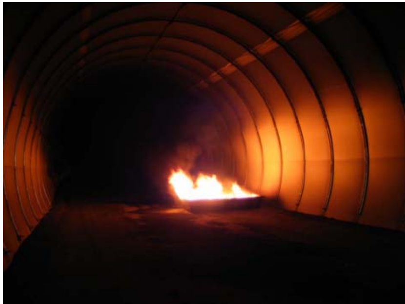
Figur 3. Brannen rett etter antennelse. Brannen har ennå ikke spredd seg fra de første to karene.
