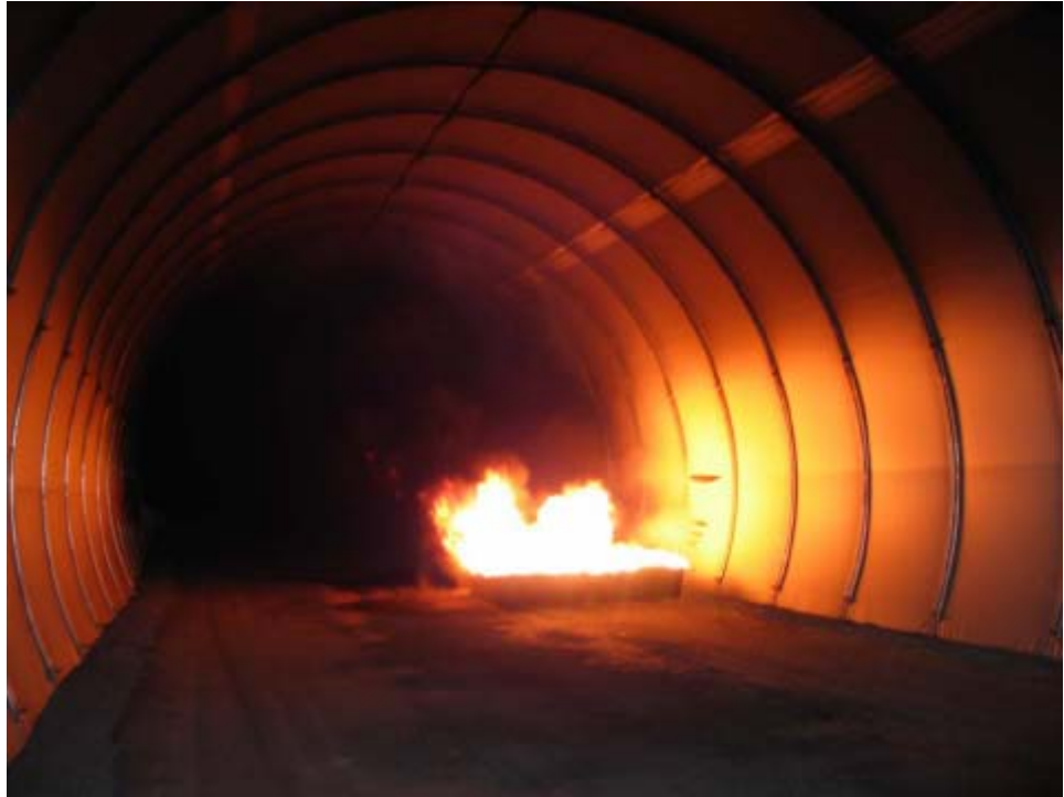
Figur 4. Brannen sprer seg til de øvrige karene. Duken begynner å sprekke nær opptil flammene.
