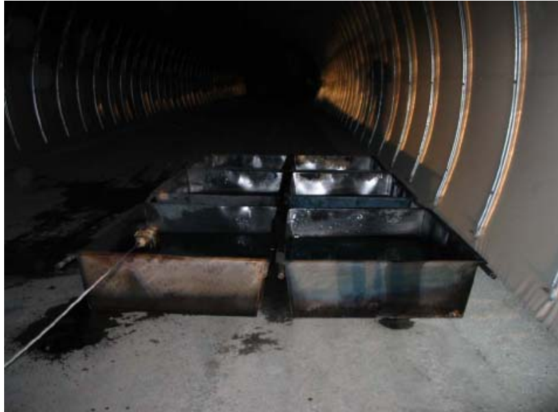
Figur 2. Karene som ble fylt med til sammen 600 liter diesel på et sjikt med vann.
