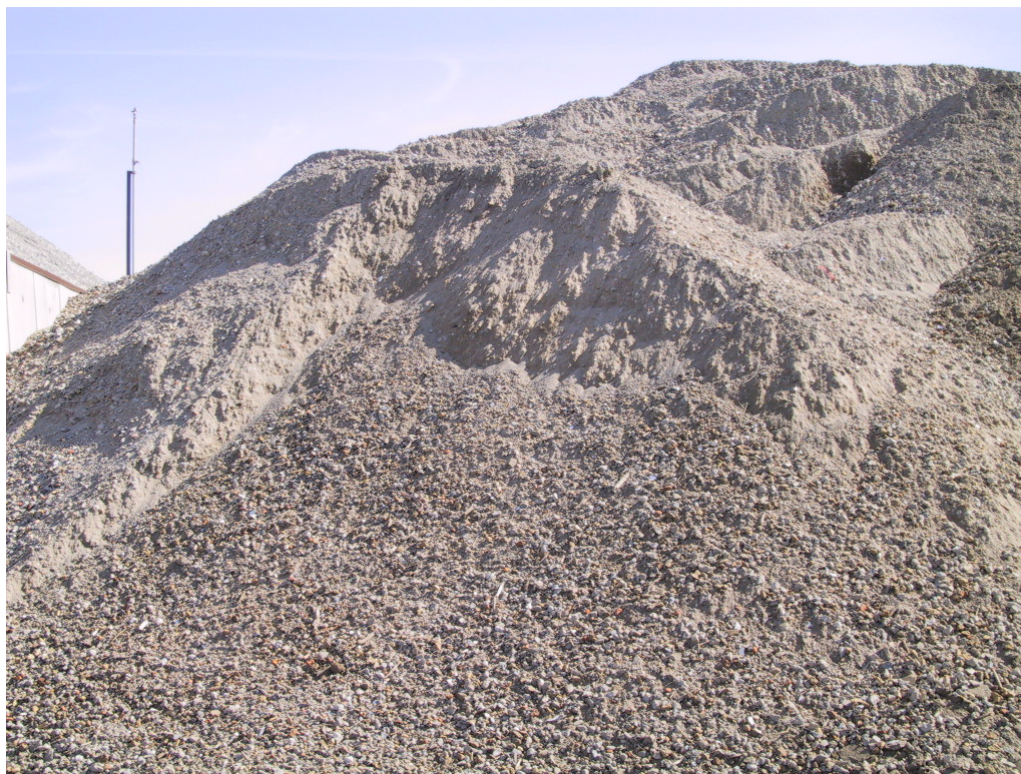
Knust betong i fraksjon 0-32 mm. RGS90 2. mai 2001.
