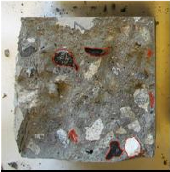
Bilde 9: Bruddflater i knekt betongprøve
