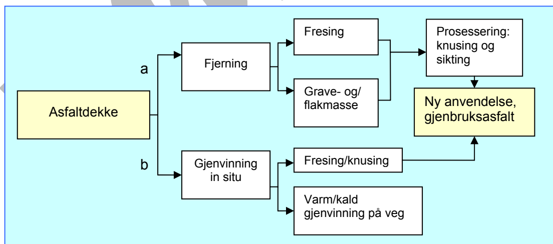
Figur 4: Prosesser ved asfaltgjenvinning: (a) fjerning av gammelt asfaltdekke ved fresing eller graving, etterfulgt med knusing og sikting; eller (b) gjenvinning på stedet
