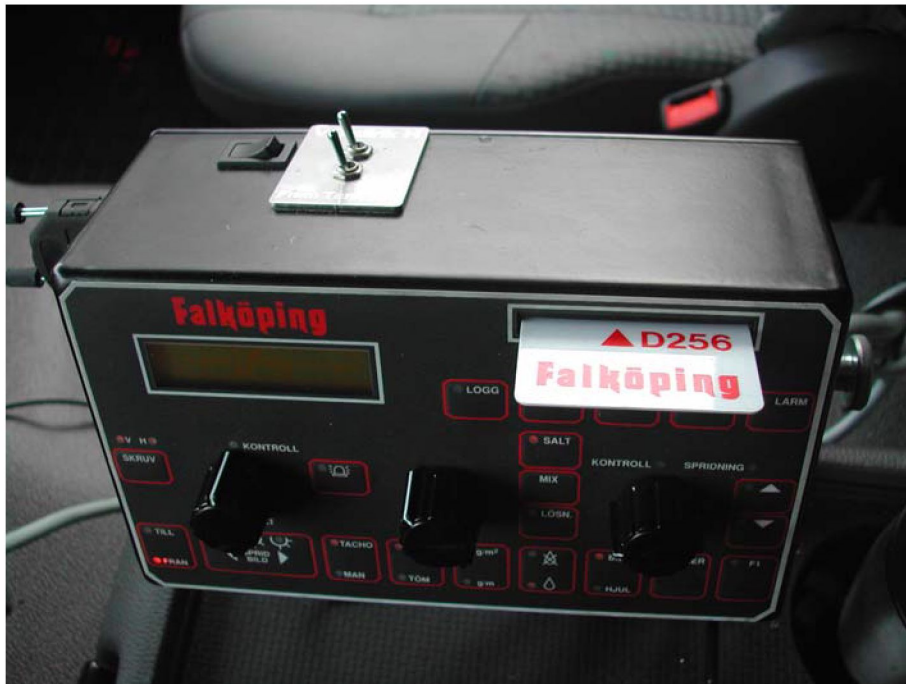
Figur 3.5: Styrepanel med hendel for å veksle mellom 2 separate løsningstanker
