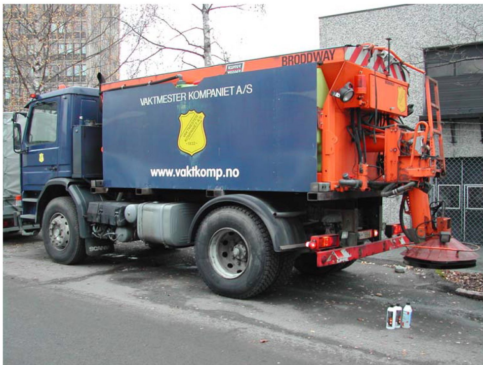
Figur 3.2: Strøbilen som er benyttet i magnesiumkloridprosjektet i Oslo til og med sesongen 2003/2004
