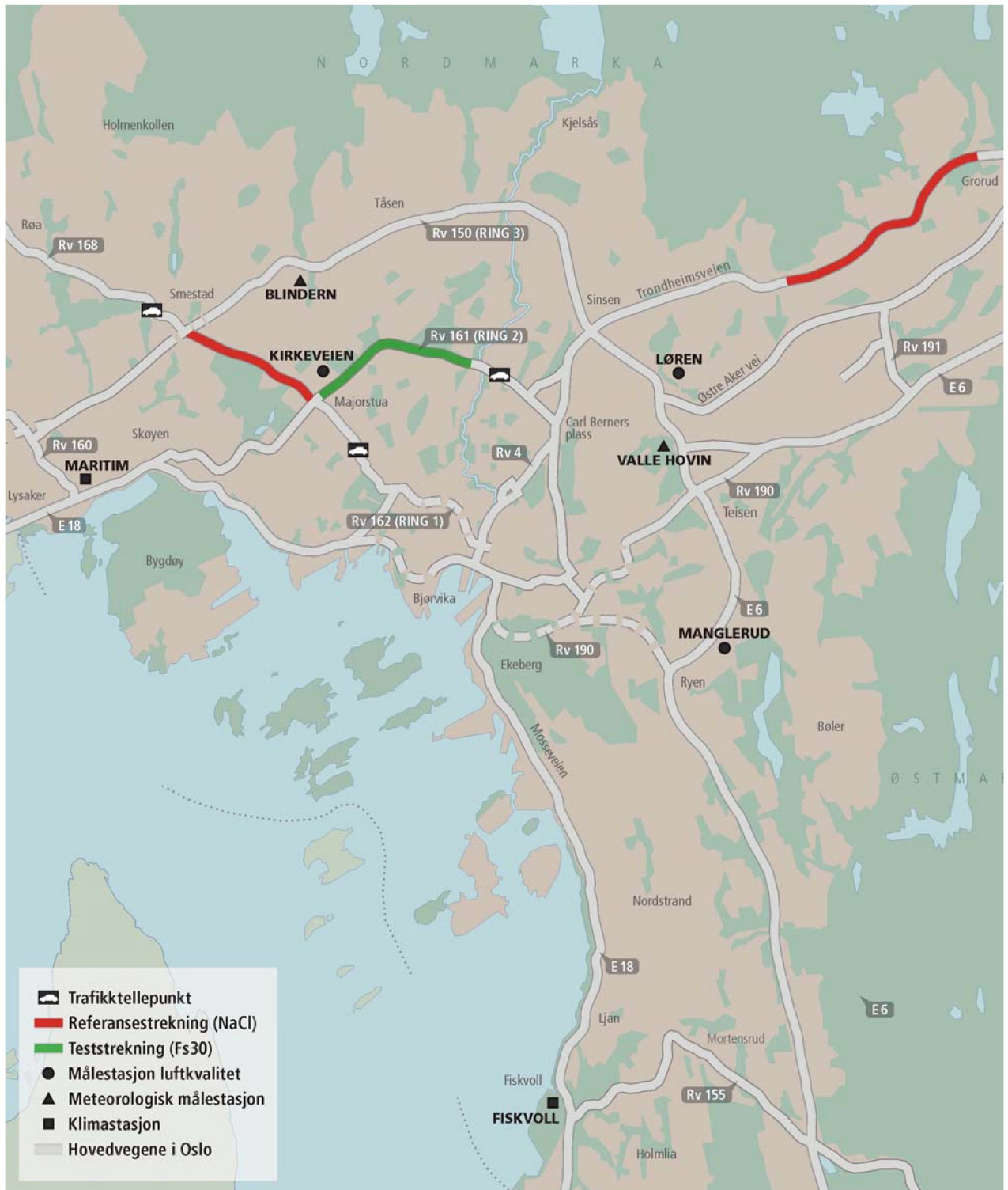
Figur 3.1: Forsøksområde hvor det er benyttet en metode med MgCl_2 -løsning som befuktning til tørt NaCl i Oslo. På referansestrekningene Sørkedalsveien (Rv 168) og Trondheimsveien (Rv 4) er det benyttet befuktning med NaCl -løsning sesongene 2001/2002 – 2003/2004. Sesongen 2004/2005 ble metodene på Kirkeveien og Sørkedalsveien byttet om
