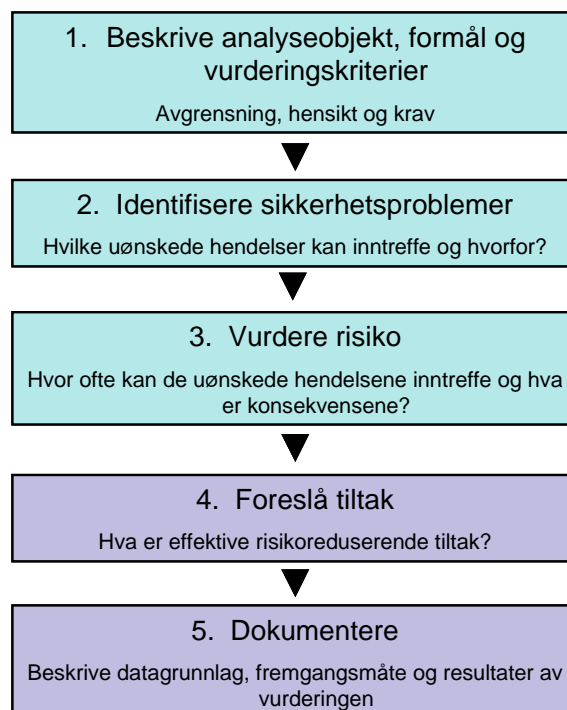
Figur 3: Femtrinnsmodell for risikovurderinger (Vegdirektoratet 2007)
