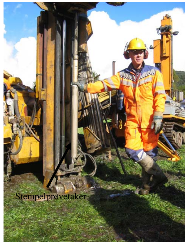
Figur 10. Opptak av uforstyrret prøvemateriale.
