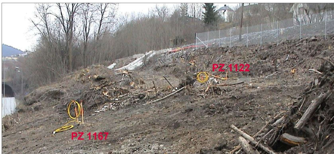
Figur 9. Plassering av poretrykksmålere (PZ) i skråningen opp mot jernbanen ca. i profil 65.
