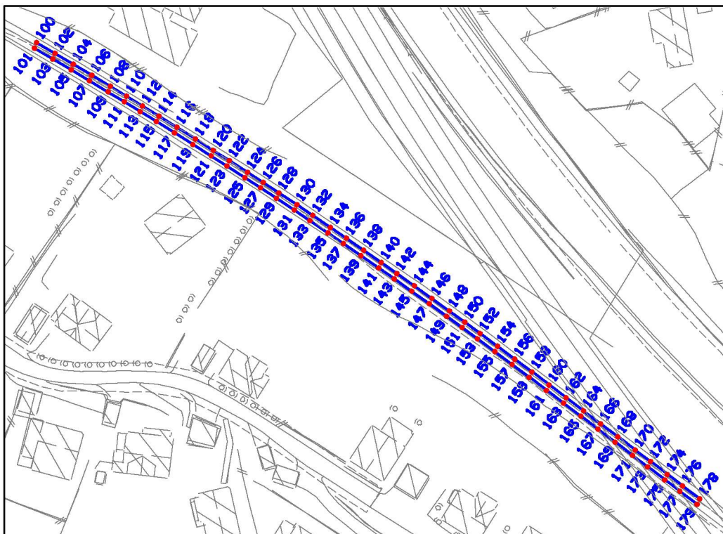
Figur 10. Plassering av målepunkter på skinnegangen for Vestfoldjernbanen.
