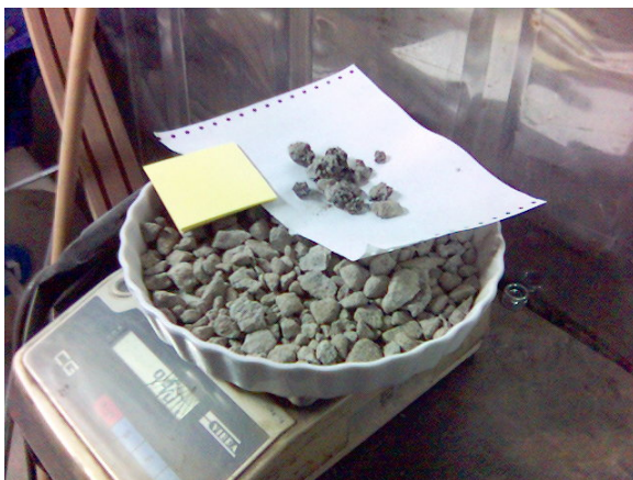
Figur 4: Fra NorBetongs blanderi: Asfalt i betongtilslaget
