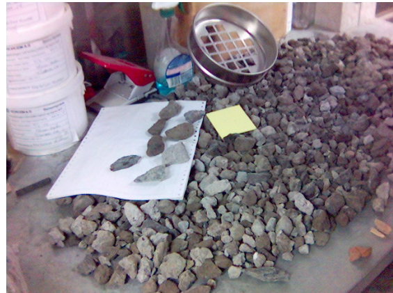
Figur 6: For grovt tilslag til betongpumpin
