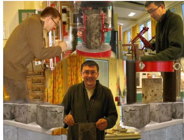
Figur 14: Laboratorium Region øst – Ian Willoughby måler E-modul
