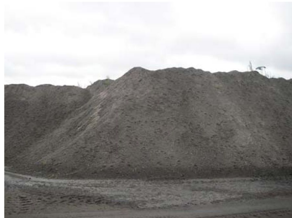
Ferdig jordblanding med slam på Fornebu. Haugen har vært utsatt for kraftig regn, uten at det synes i overflaten
