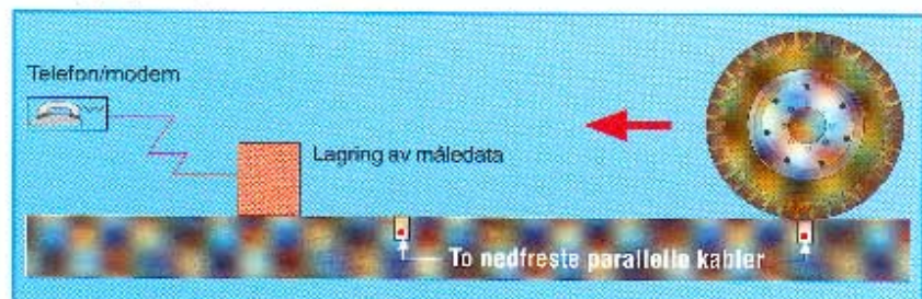
Figur 2.1 Prinsippkisse av målepunkt for automatisk vektregistrering.
