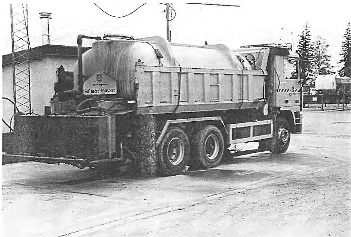
Figur 12 Utstyr for utspredning av lignin (Dustex)
