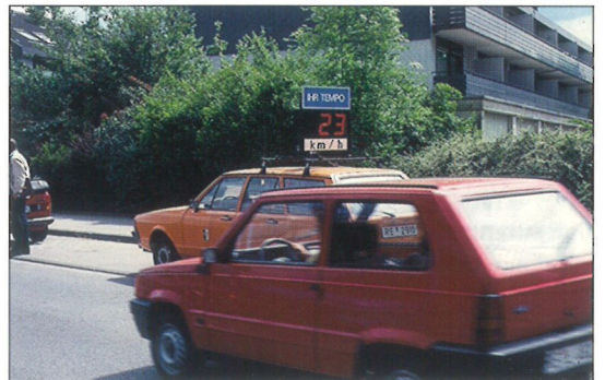
Figur 8: Fartskontroller. Bildet viser at bilen i forgrunnen har en hastighet på 23 km/t.
