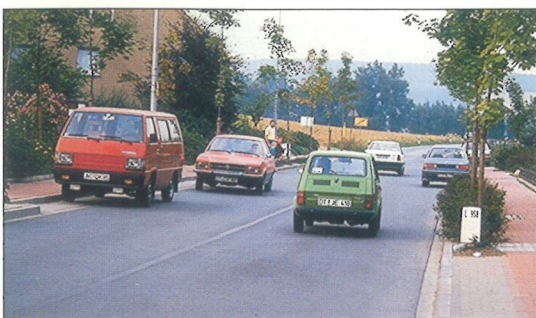
Figur 74: Sideforskyvning ved hjelp av parkeringsfelt på vekslende side av gaten
