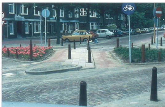
Figur 48: Kryss med delvis sperring og sykkelsluse
