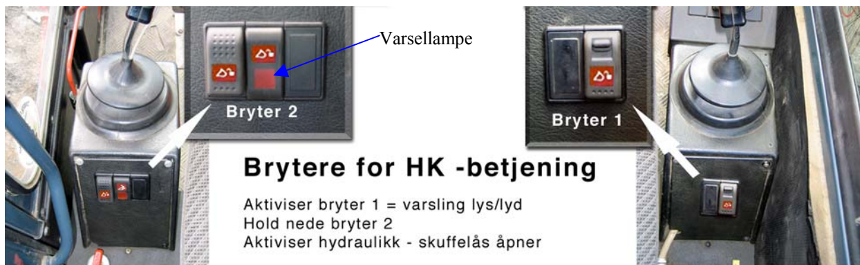
Bilde nr. 7 Kontrollpaneler på O&K RH 6 PMS 1989 modell med ettermontert 2-håndsbetjent manøvrering av hydraulisk HK-feste.
