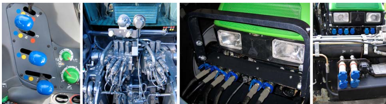
Bilde nr. 9 DEUTZ Agroton traktor: Er merket fra fabrikk, men hvilken kobling er hva på tilleggsutstyr?
