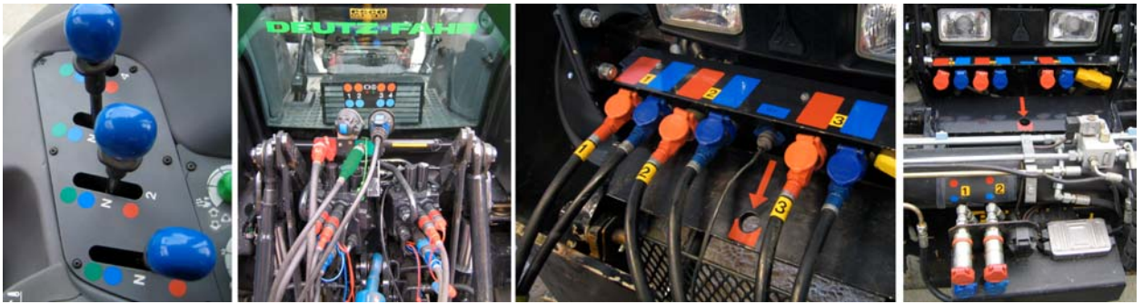
Bilde nr. 10 DEUTZ Agrotron traktor: Varselmerking med farger på oljeuttak og elektriske kontakter.
