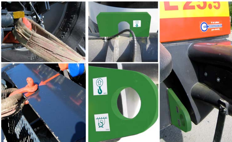
Bilde Nr 23 Varselmerking med farge på traktor og anleggsmaskin: Slepefester rød, løfte- og surrepunkter med grønn farge. OBS! Rød merking av sjakkel på slepestropp må ikke forveksles med årlig fargekode på løfteredskap.
