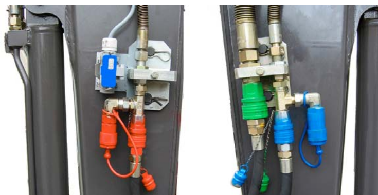
Bilde nr. 14 VOLVO kompaktgraver med fargekoding
