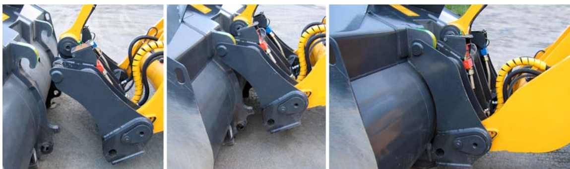
Bilde nr. 19 O&K hjullaster med HK-feste, type VOLVO – montering av original lasteskuffe.
