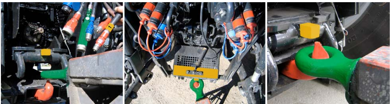
Bilde Nr 22 Varselmerking med farger på traktor: Trekkrok / hengerfeste, rød med gult mothold og grønt hengerøye
