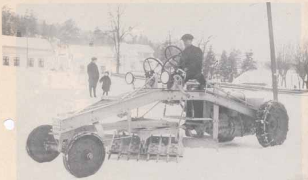
“Drafn” veghøvel fra Drammens Jernstøberi & Mek. Verksted. Tidlig årsmodell.
