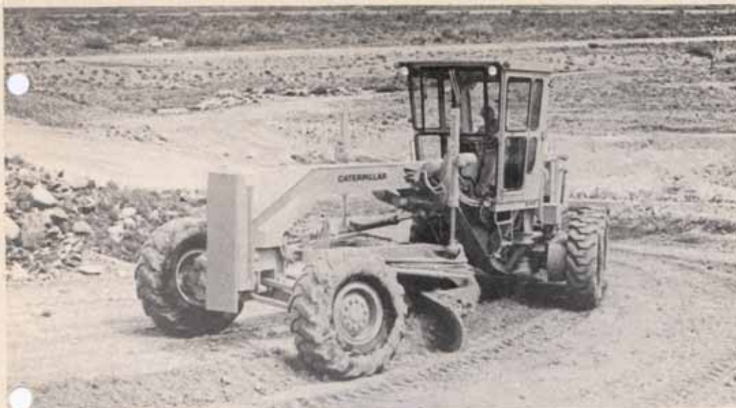
Veghøvel med ramme- styring, totalvekt ca 15 t
