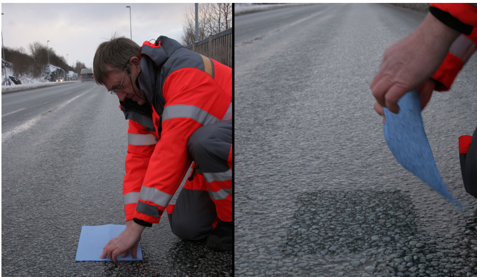
Figur 4. Utførelse av fuktmålingen og resultatet etter absorbering av vannet.
