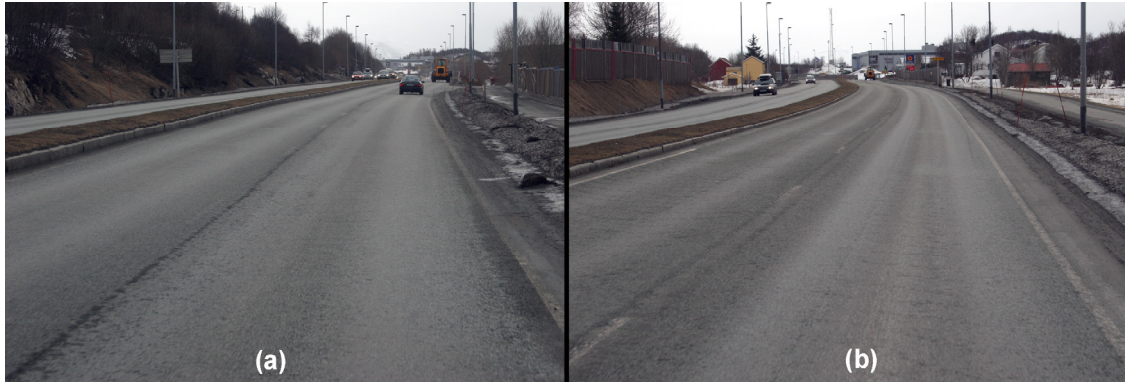
Figur G-4. Oversiktsbilde av (a) referansestrekning, og (b) teststrekning, 24 timer, og 12500 kjøretøypasseringer etter tiltak. Bildene er tatt kort etter hverandre under samme lysforhold. På teststrekningen kan man fortsatt se buene av testløsning, som var ikke synlig på referansestrekningen.
