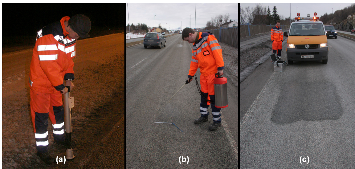
Figur 2. (a) SOBO20 restsaltmåleren i bruk, (b) befuktning av vegbanen, og (c) vegbanen etter befuktning før saltmålingene ble foretatt.
