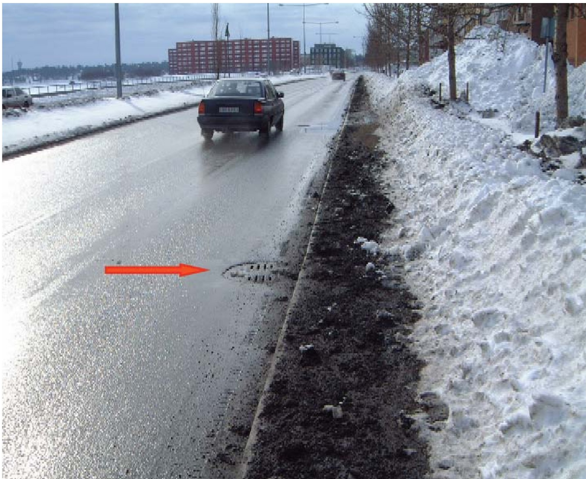
Figur 46. Viser inntakssluk for smeltevann brukt ved måling av avrenning fra brøytesnø langs kanten av en motorveg i Luleå (Fra Westerlund et al. 2009).
