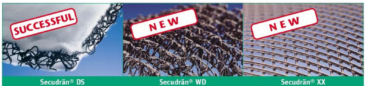
Figur 30. Viser ulike typer drenermatter (Secudrän) brukt for å drenere vann over membran fram til drensør i membranløsninger for å beskytte grunnvann under nye veger ( www.naue.com ).
