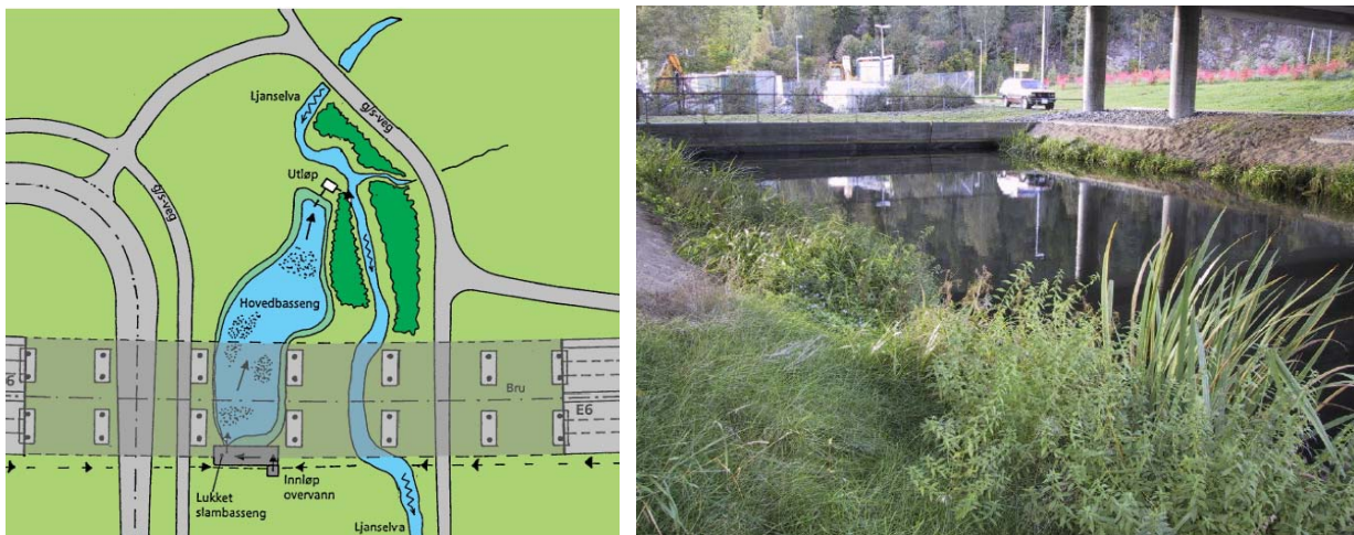
Figur 11: Rensedam ved E6 Skullerud i Oslo med helstøpt og lukket sedimentasjonskammer og vanddyb 1,5 m (Fra Åstebøl og Coward 2005).
