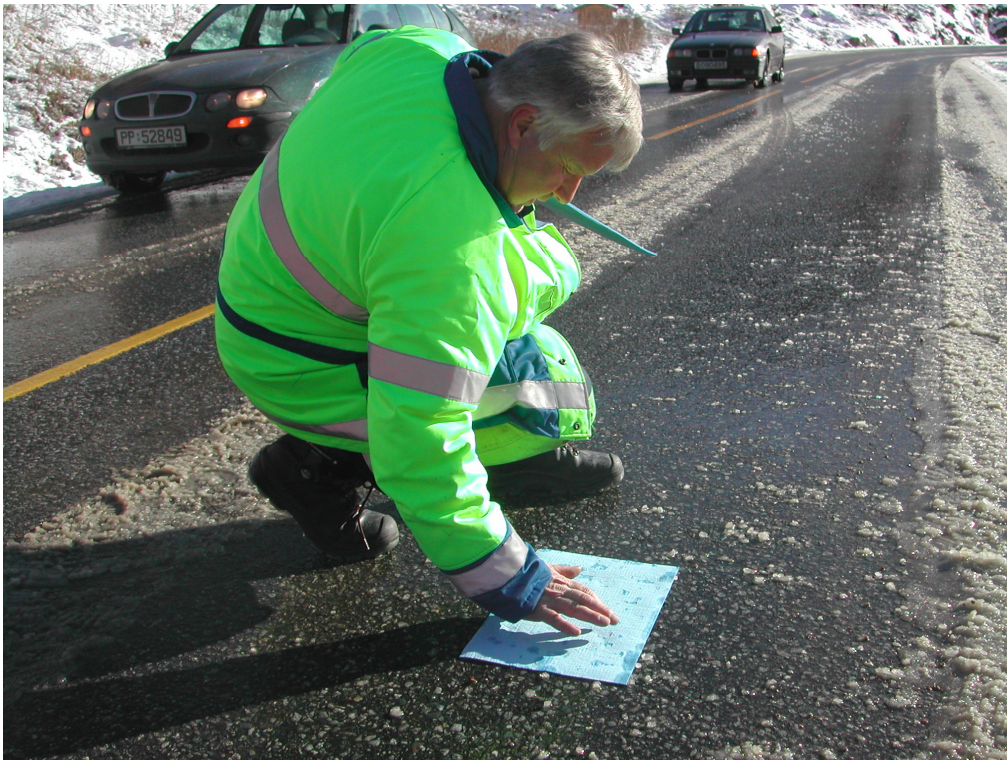
Figur 3.11: Oppsamling av fuktighet med Wettex klut
