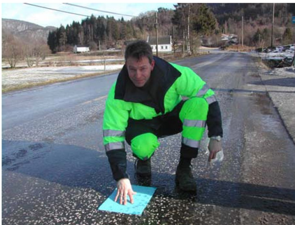
Figur 2.15: Oppsamling av fuktighet med Wettex klut
