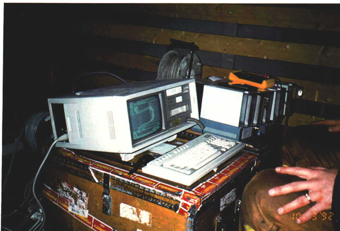
Figur 7 Lastpåføring styres fra PC
