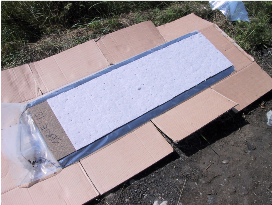
Figur 5. Trefiberplate (12,5 · 40 cm) til kontroll av bindemiddelforbruk
